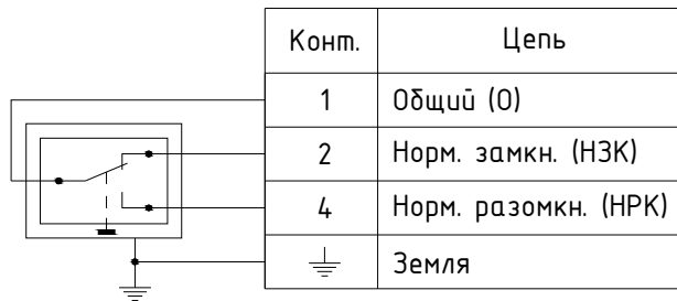
Рисунок В2б. Электрическая схема подключения реле давления
