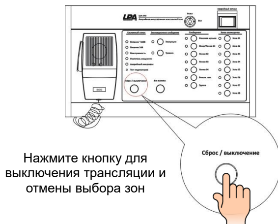
Рис. 4.3. Отмена выбора зон на микрофонной консоли LPA-EVA-FM
