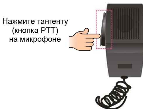
Рис. 4.2. Включение тангентного микрофона консоли LPA-EVA-FM
