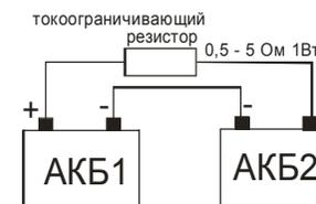
Рис.2 - Схема подключения аккумуляторов для выравнивания напряжений
