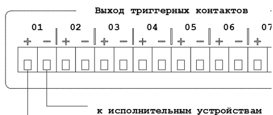
Рис. 3.5. Схема подключения внешних исполнительных устройств к LPA-PRESTA-16.
