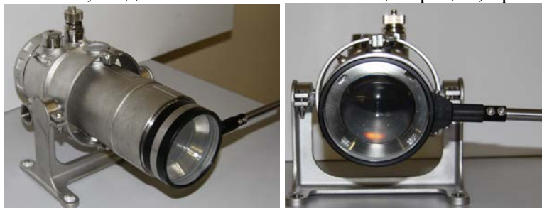
Рисунок №30 Установка тест-пластины.
