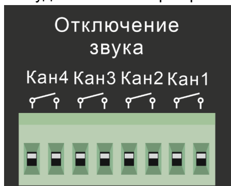
Рис.2.9. Входы отключения трансляции
