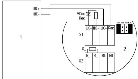
**a) подключение на размыкание**
