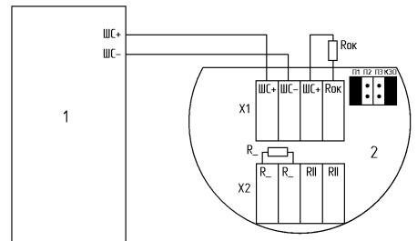
**a) подключение на размыкание**
