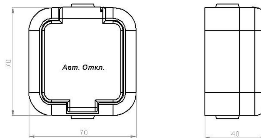
Рис. 2 Габаритные размеры считывателя.
