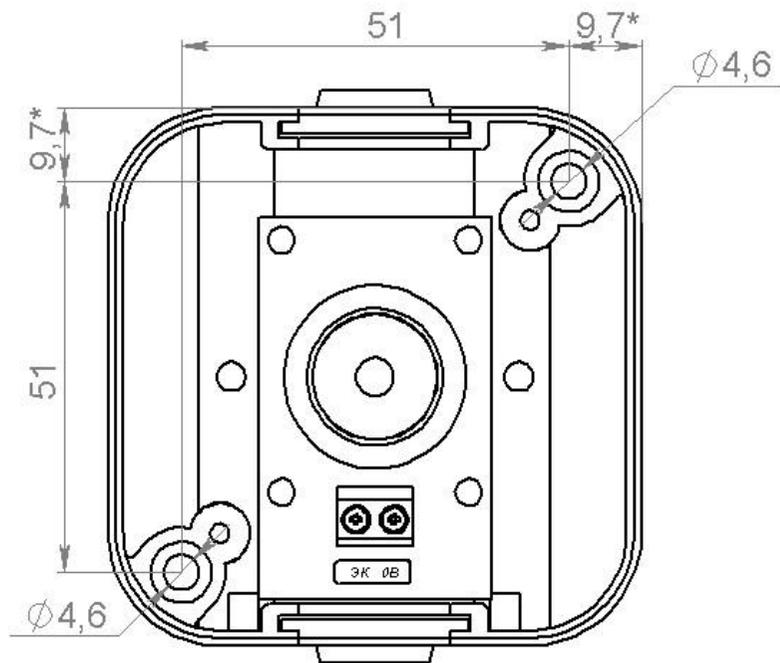
Рис. 3 Установочные размеры считывателя.
