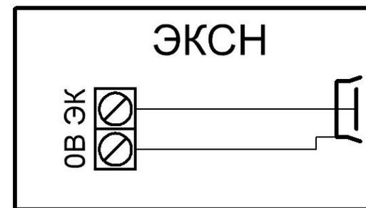
Рис.1 Схема подключения считывателя.
