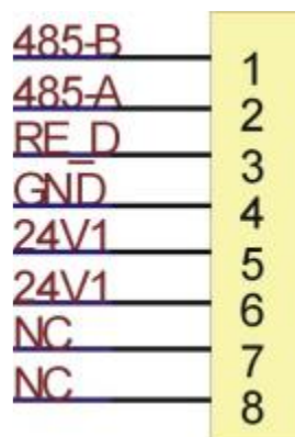
Рис.4 Назначение контактов в разъёме RJ45
