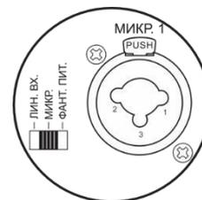
1. При переключении на линейный вход вы можете подключить к микшеру-усилителю линейный источник сигнала, например, CD, VCD, DVD и другое внешнее аудио оборудование.
