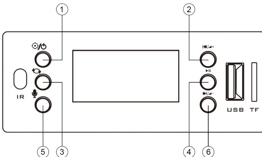
1. Кнопка **ВКЛ/РЕЖИМ**. Длительное нажатие приводит к включению устройства. Кратковременное позволят переключать режимы **FM/USB/Bluetooth**.
