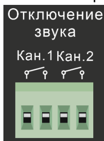
Рис.2.9. Входы отключения трансляции
