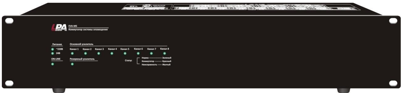
Рис. 3.1. Внешний вид коммутатора усилителей LPA-EVA-MS
