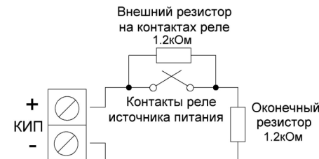
Рисунок 3. Подключение шлейфа контроля источников питания
