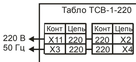
Рисунок Б.3 – Схема подключения табло ТСВ-1-220, ТСВ-1Р-220, ТСВ-1Х-220 и ТСВ-1С-220 (питание переменным напряжением 220 В, 50 Гц)
