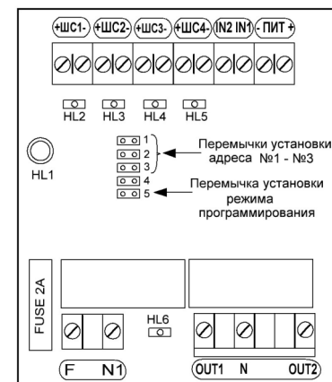
Рисунок 3 - Расположение индикаторов и перемычек на плате БКК
