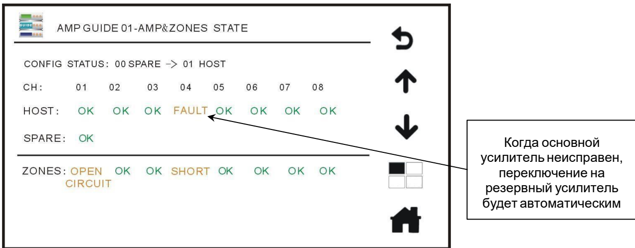
Рис. 4.13. Состояние переключения на резервный усилитель в окне
