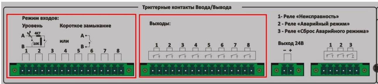
Рис. 4.9. Фрагмент задней панели LPA-EVA-MA с разъемами входов-выходов управляющих сигналов
