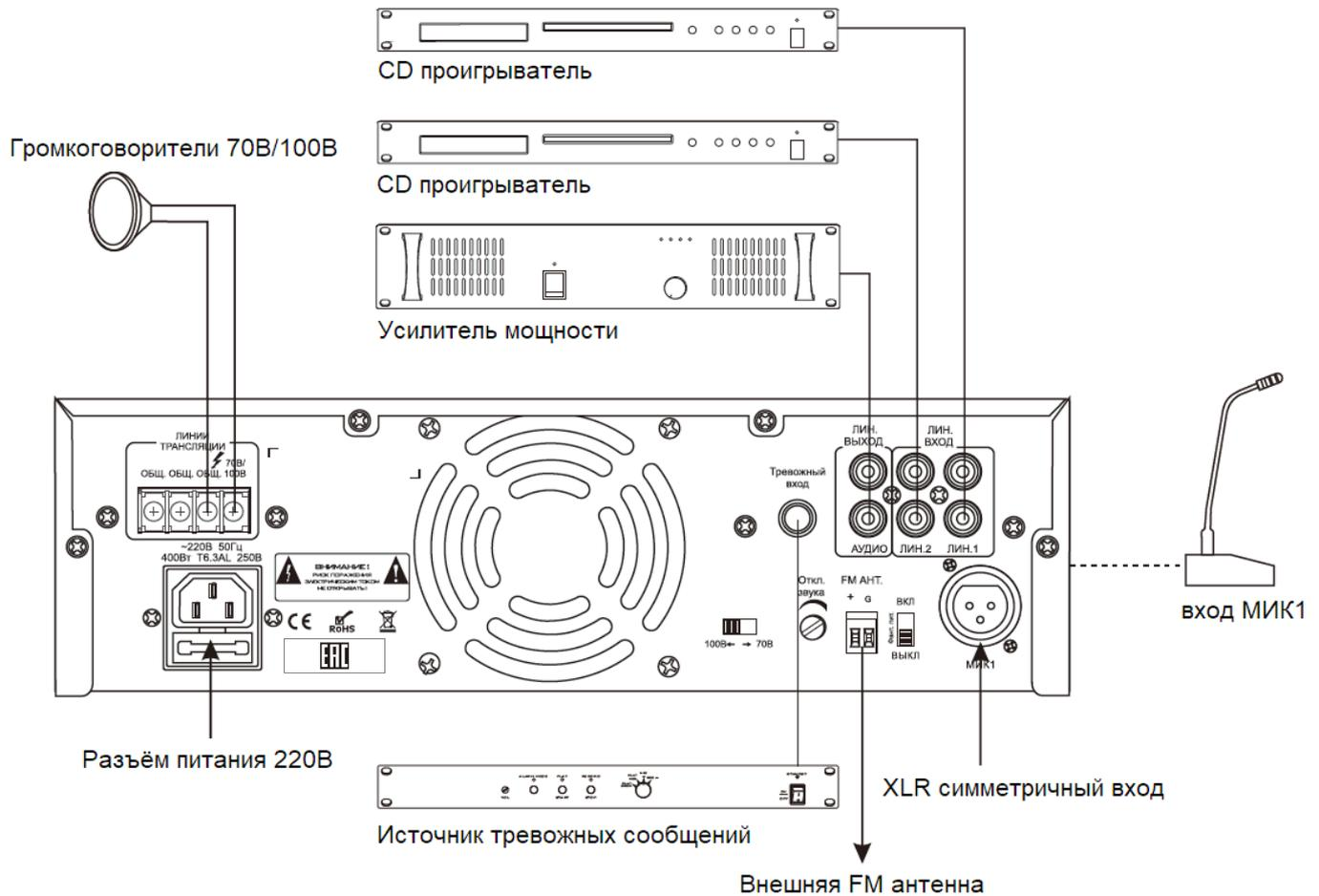
Рис. 2.1. Схема подключения LPA-TA-120M
