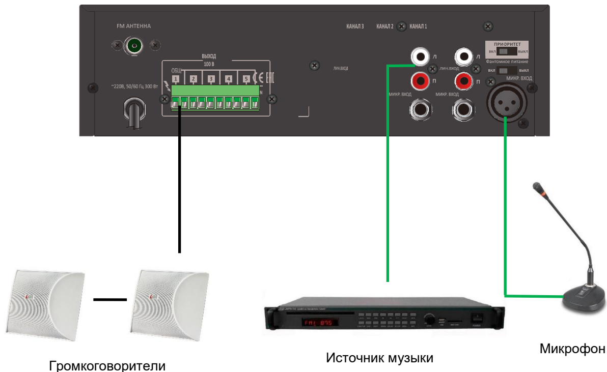
Рис. 2.1. Схема подключения LPA-TA-240MZ
