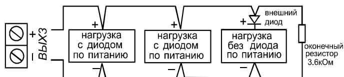
Рис.3 - Схема подключения нагрузки к выходу «ВЫХ3»
