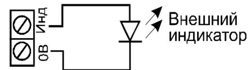
Рис.9. Схема включения индикатора
