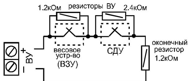
Рис.3. Схема включения датчиков в шлейф контроля ВУ
