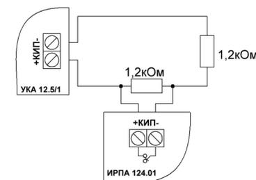
Рис. 7. Схема подключение шлейфа КИП
