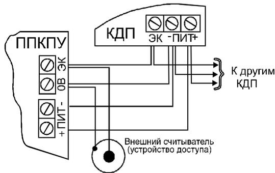
Рис. 8. Схема подключения считывающего устройства и КДП
