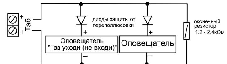
Рис. 6. Схема включения нагрузки с сопротивлением менее 300Ом
