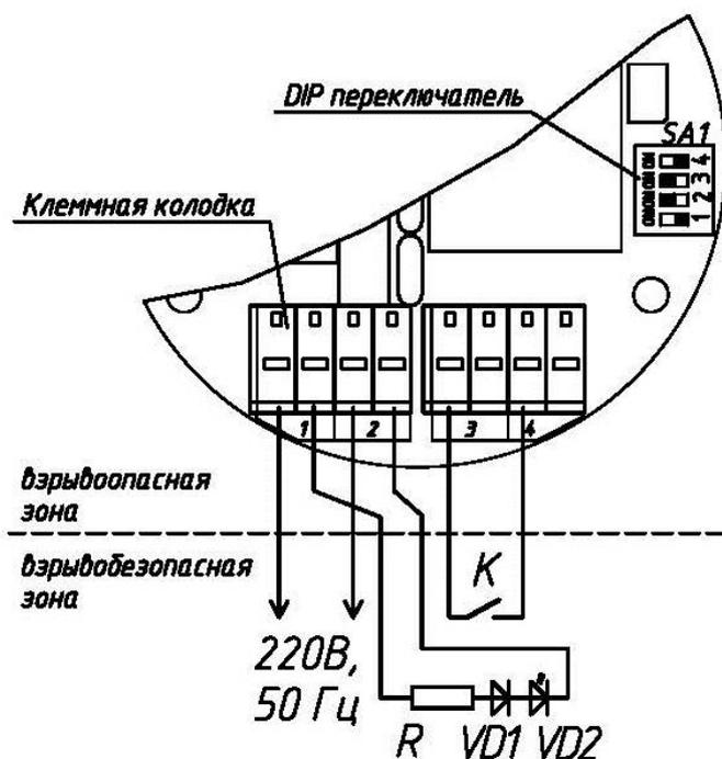
Рекомендуемые параметры схемы контроля линии при напряжении 220 В, 50 Гц:
