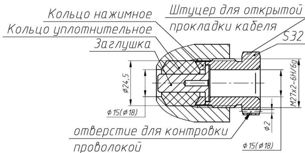
Рисунок А.4 Элементы взрывозащиты кабельного ввода для открытой прокладки кабеля, на рисунке показан вариант с заглушкой.
