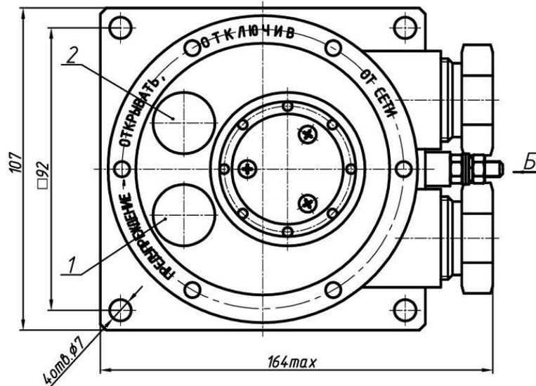
Рис. А.1 Габаритный чертёж Оповещателей моделей ExOPZS-N в корпусе из нержавеющей стали, совмещённый с чертежом взрывозащиты
