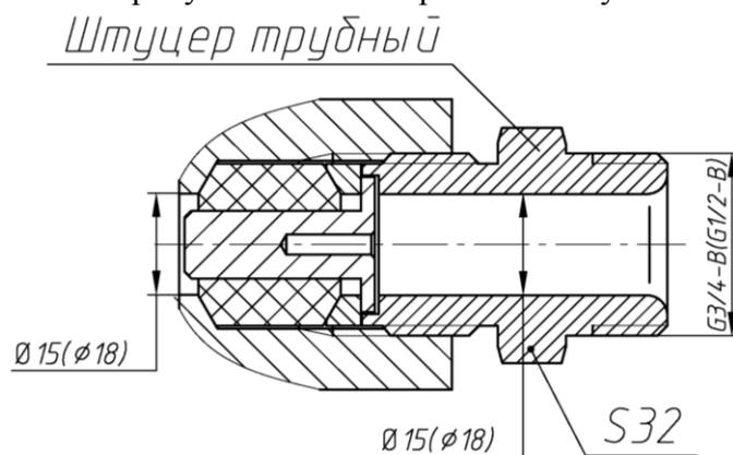
Рисунок А.5 Элементы взрывозащиты кабельного ввода для прокладки кабеля в трубе. Диаметр кабеля для штуцера с резьбой G1/2 – от 8 до 12 мм, штуцера с резьбой G3/4 – от 8 до 18 мм.
