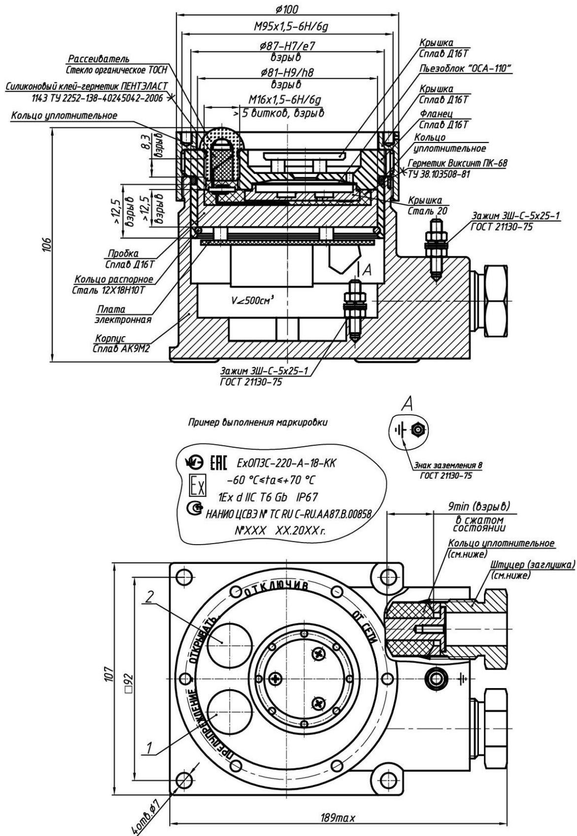
Рис. А .2 Габаритный чертёж Оповещателей моделей ExOP3C-A в корпусе из алюминиевого сплава, совмещённый с чертежом взрывозащиты
