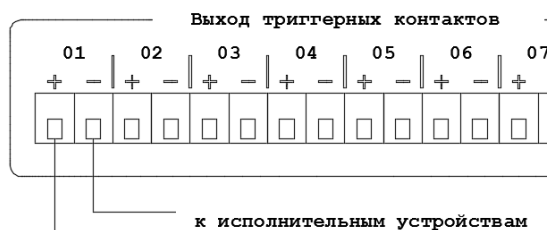
Рис. 3.5. Схема подключения внешних исполнительных устройств к LPA-PRESTA-2.
