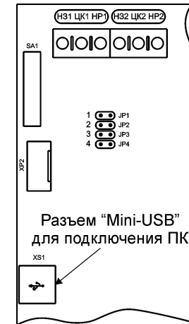
Рисунок 16. Расположение разъёма Mini-USB на базовой плате ПУ
