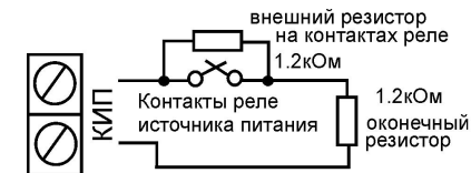
Рисунок 7. Подключение шлейфа контроля источников питания
