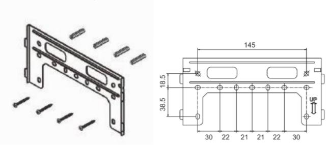
Устройство поддерживает возможность настенного монтажа. Способ установки:
